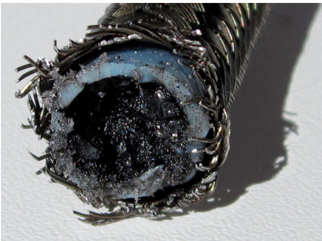
Wettbewerbsprodukt – Schmierstoffzuleitung durch Ablagerungen blockiert Competitive product – Feed pipes clogged up with deposits
