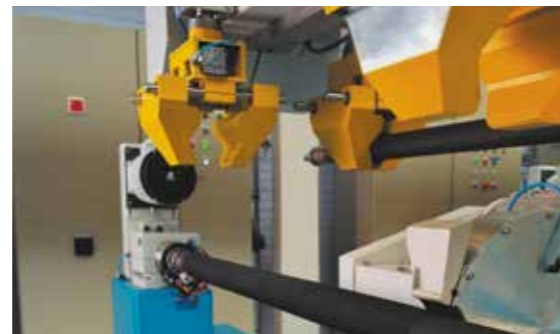
Da selbst eine geringe Abweichung von 1mm in der Wandstärke die Lebensdauer eines Pumpenelementes um 25% verringern kann und um gleichbleibende Leistungen zu gewährleisten, wird jedes Pumpenelement präzisionsbearbeitet.
